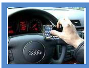
En fonction de vos capacités, des contacteurs peuvent être installés au niveau de l'appui tête, de la portière, du tableau de bord...
