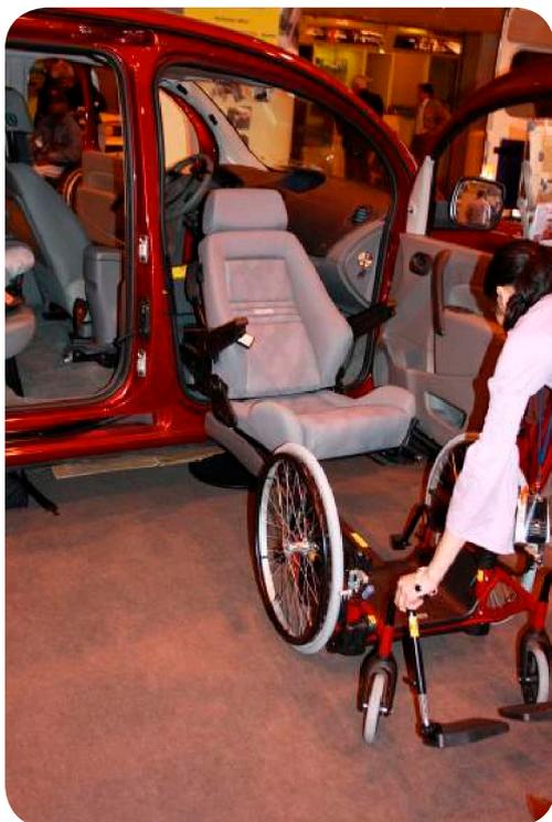
*Siège pivotant avec embase roulante*
